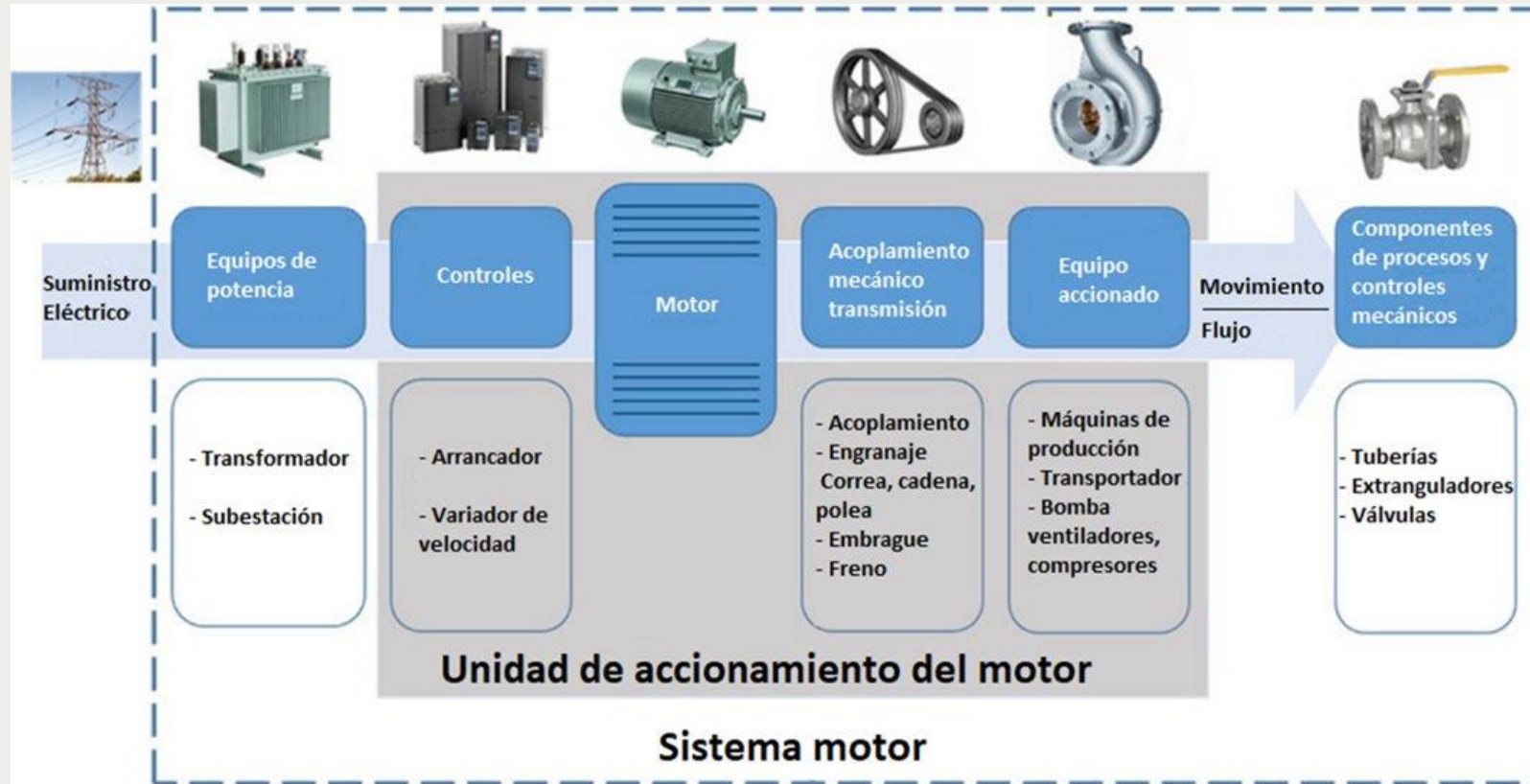
Componentes de un sistema motor eléctrico
